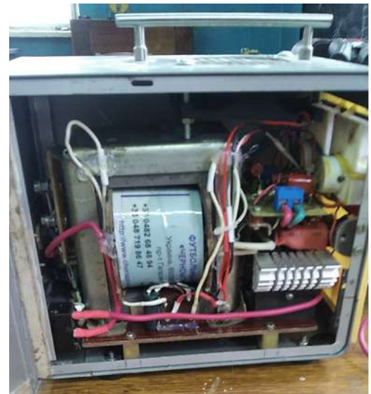
Рис. 6. Внешний вид и конструкция предлагаемого зарядного устройства
