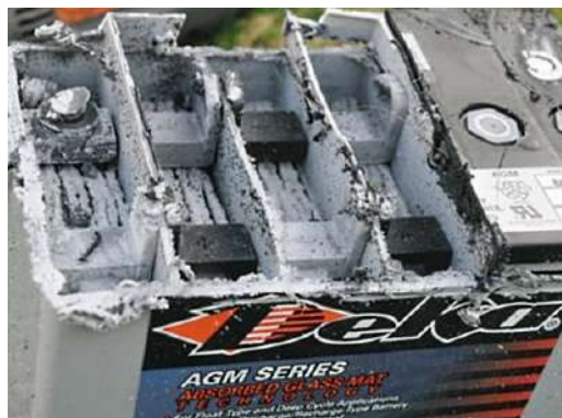
Рис. 1. Пример сульфатации пластин аккумулятора
