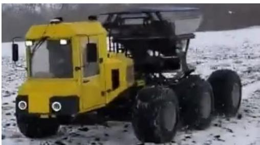
Рис. 2. Прототип самоходного шасси «Барс 2.0»
