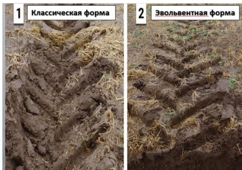
Рис. 5. Результат применения грунтозацепов различающихся по форме.
