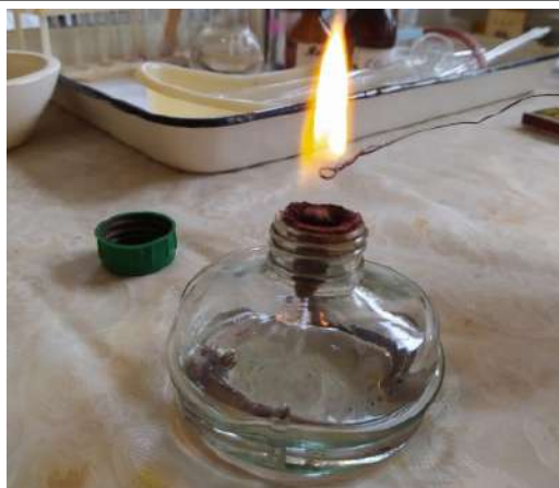
Рис. 2. Результат пирохимической пробы глазных капель сульфацила на наличие ионов натрия
