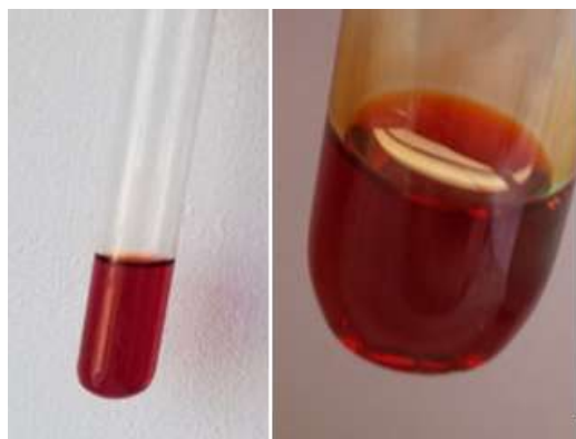
Рис. 1. Образование азокрасителя, результат реакции глазных капель сульфацила натрия после диазотирования и азосочетания с \beta -нафтолом
