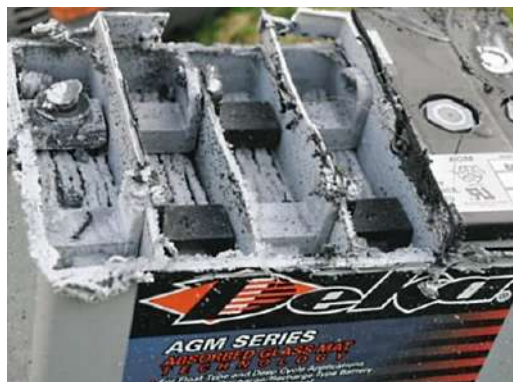
Рис. 1. Пример сульфатации пластин аккумулятора
