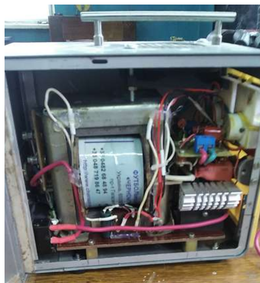
Рис. 6. Внешний вид и конструкция предлагаемого зарядного устройства
