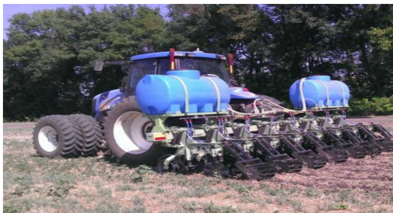
Рис. 5. Трактор Нью-Холланд с навигационным оборудованием и культиватор Orthman 1tRIPr с приспособлением для локального внесения удобрений в полосы
