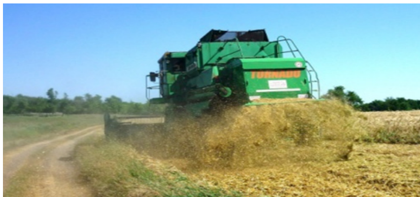
Рис. 9. Уборка урожая зерноуборочным комбайном с усовершенствованным измельчающим устройством, обеспечивающее качественное измельчения
