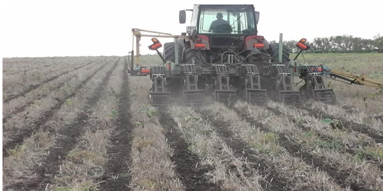
Рис. 4. Нарезка полос МТЗ-1523 + культиватор Ортман с маркерным устройством
