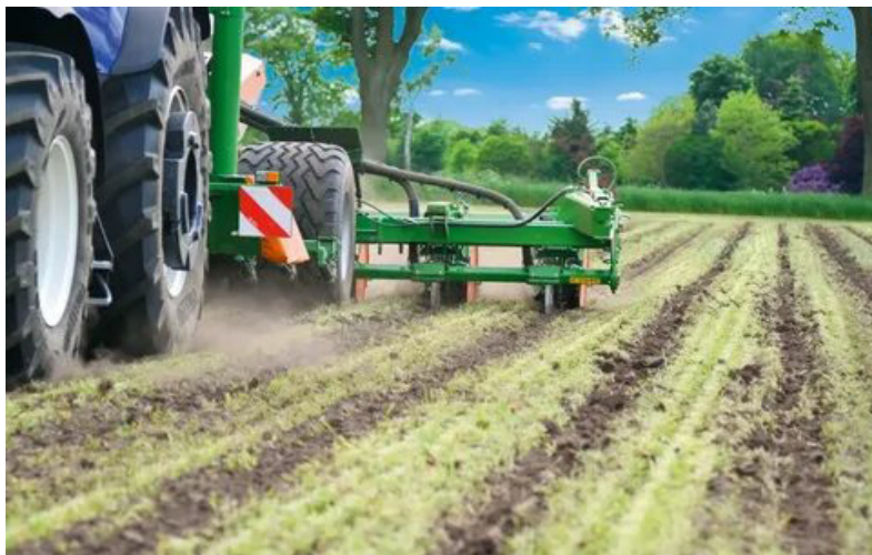
Рис. 7. Посев семян пропашных культур весной отдельной пропашной сеялкой в узкие взрыхленные полосы, нарезанные и подготовлены в осенний период
