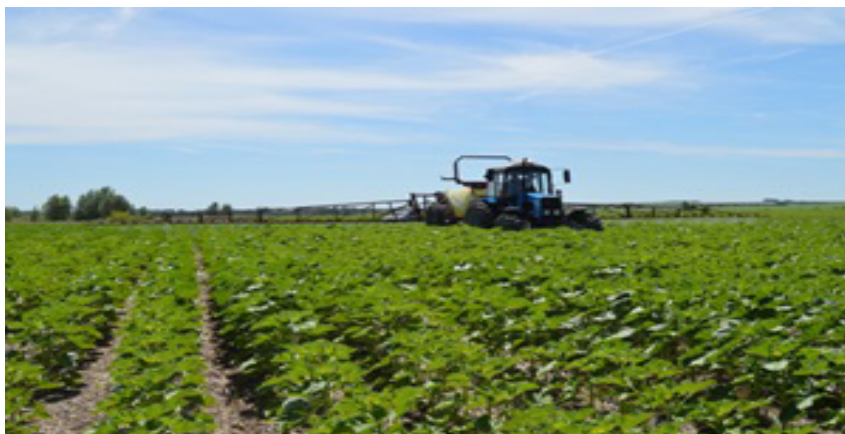
Рис. 6. Проведение полосового опрыскивания подсолнечника с боковым распылом модернизированным штанговым опрыскивателем Hardy Novigator-3000
