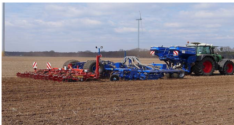
Рис. 8. Комбинированный агрегат KÖCKERLING Master в составе специального культиватора с приспособлением для внесения удобрений и пропашной сеялки
