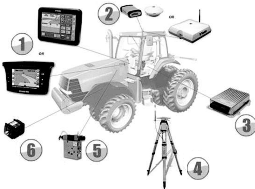
Система автоматизации вождения:
