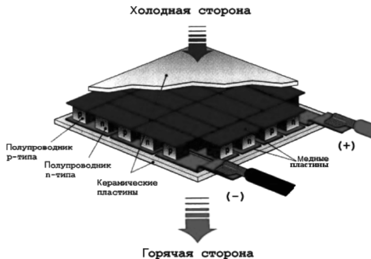
Рис. 6. Принцип действия термоэлектрического модуля
