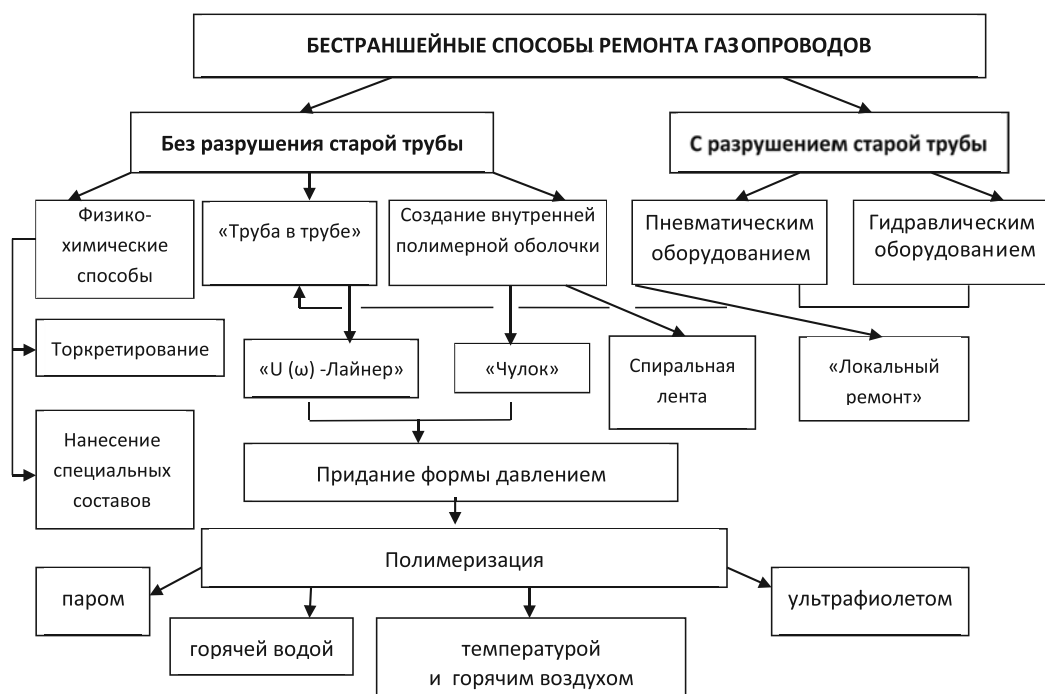
Рис. 1. Классификация бестраншейных способов ремонта трубопроводов
