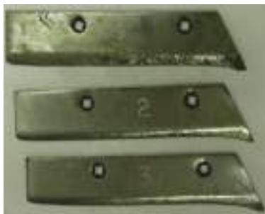
Рис. 1. Состояние рабочих поверхностей экспериментальных образцов правых лемехов плуга: 1 – упрочненный титан-кобальтовым сплавом Т15К6; 2 – серийный; 3 – упрочненный сплавом сормайт-1
