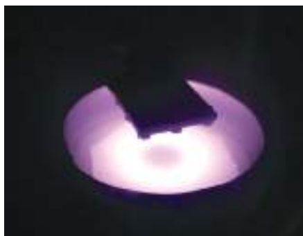
Рис. 3. Осаждение слоев AlN в высокочастотном разряде
