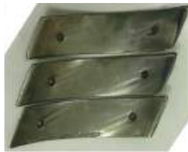
Рис. 2. Состояние рабочих поверхностей экспериментальных образцов вертикальных удлиненных лемехов плуга: 1 – упрочненный титан-кобальтовым сплавом Т15К6; 2 – серийный; 3 – упрочненный сплавом сормайт-1
