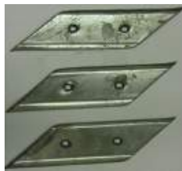
Рис. 3. Состояние рабочих поверхностей экспериментальных образцов левых противодействующих лемехов плуга: 1 – упрочненный титан-кобальтовым сплавом Т15К6; 2 – серийный; 3 – упрочненный сплавом сормайт-1
